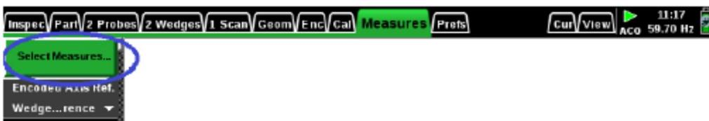
3. Sélectionner une des entrée de mesure (1 à 5), et presser pour la modifier.
