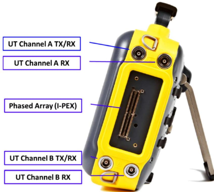
Pour brancher une sonde phased array, dévisser le capot de protection et le placer au dos de l'appareil (au-dessus du marquage CE).
