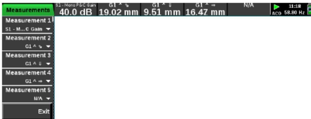
Chaque item mesure comprend 3 parties; le curseur d'identification, le point de référence et le type de mesure. Par exemple, "G2 ^ ↓" signifie "la profondeur du pic détecté dans la porte 2, mesure sur crête".
