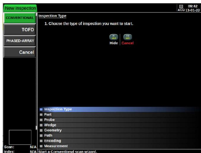
4. Sélectionner le type d'inspection ( US conventionnel, TOFD ou multiélément) et appuyer sur
